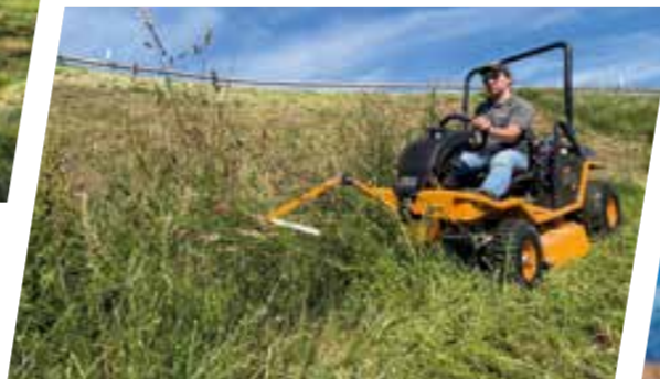
Insektenschonendes Mähen mit Scheuchvorrichtung
