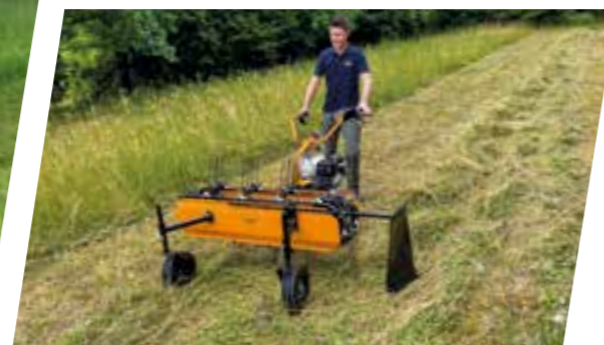
Absammeln von Schnittgut mit Bandrechen
